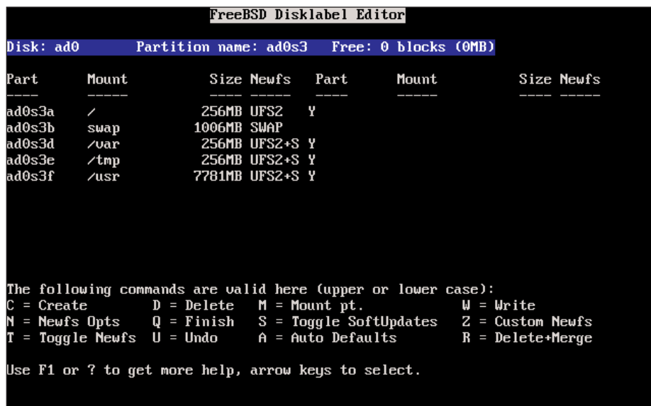
Figura 5.- Dejaremos que el instalador cree particiones en la rodaja de FreeBSD de forma automática y les asigne los tamaños predeterminados.
